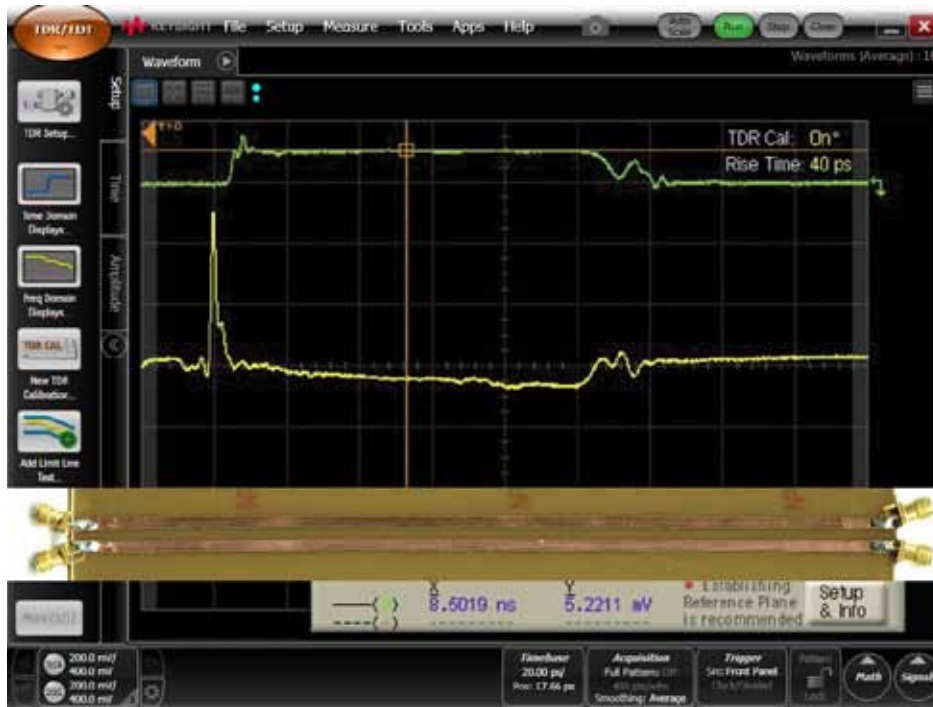
Рисунок 37. Измерение NEXT в пассивной линии с помощью маркера.
