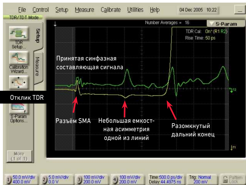
Рисунок 62. Измеренное преобразование дифференциального сигнала в синфазный, вызванное асимметрией линий пары.
