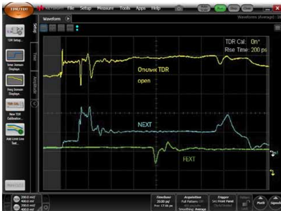
Рисунок 41. Измеренные NEXT и FEXT в 610-миллиметровой дорожке материнской печатной платы с терминированными концами.
