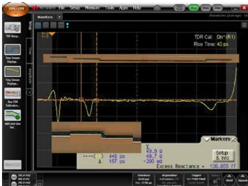
Рисунок 18. Применение маркеров для извлечения избыточной ёмкости двух углов.
