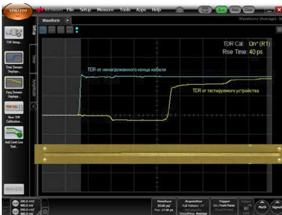
Рисунок 1. Измеренная рефлектограмма (осциллограмма при TDR) микрополосковой линии передачи. Синяя кривая представляет отражение от конца кабеля; жёлтая кривая представляет сигнал, отражённый от ТУ.
